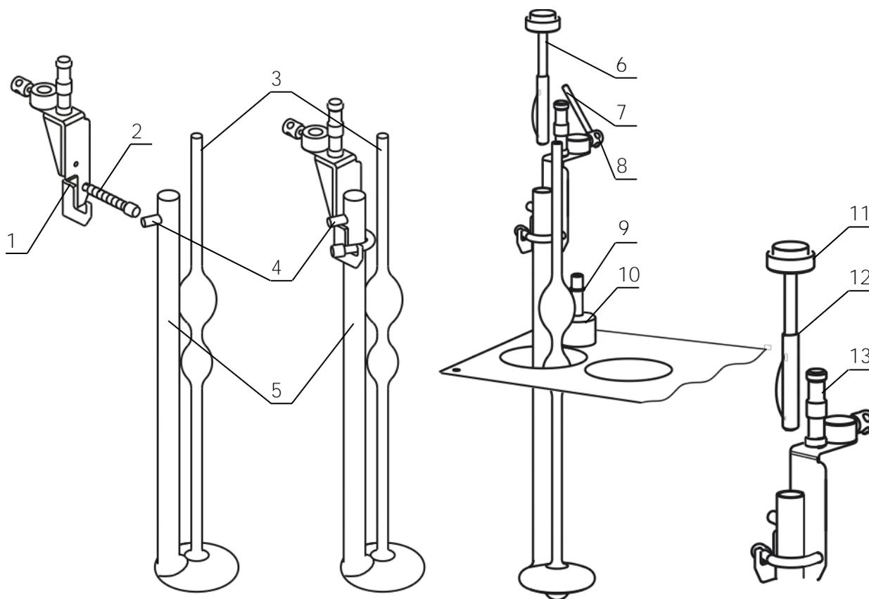
Рисунок 5 — Установка вискозиметров
